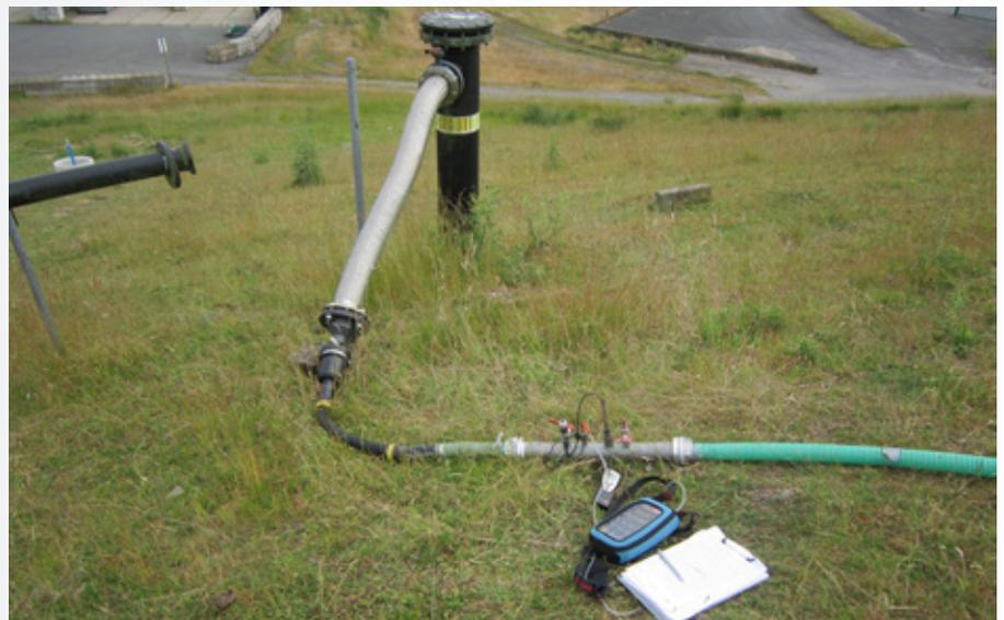
Abb. 2: Belüftungsversuche an Gasbrunnen im Juni 2015
